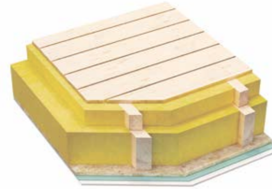
Aufbau der Kehlbalkendecke zum unbeheizten Spitzboden
