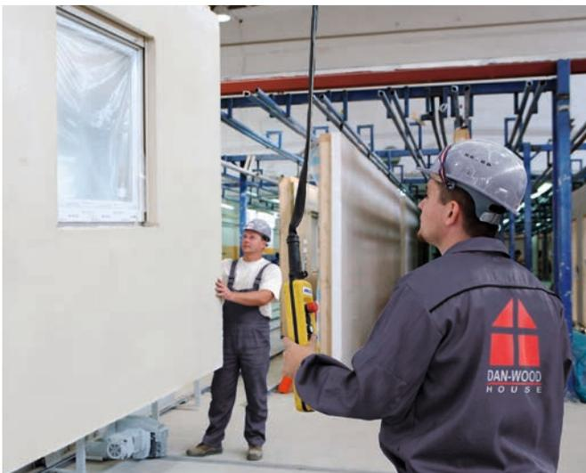
Die Wände werden in der Fabrik vorgefertigt...
