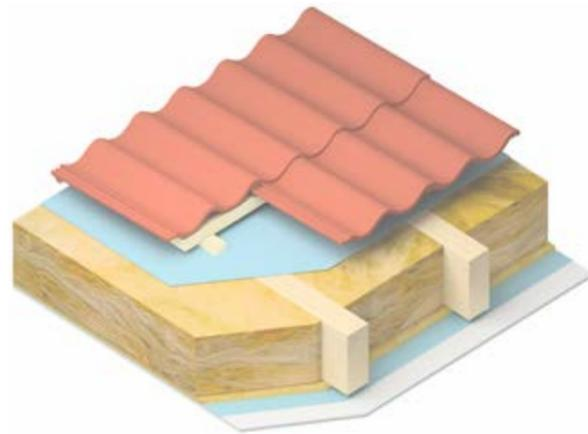
Schema der Dachkonstruktion
