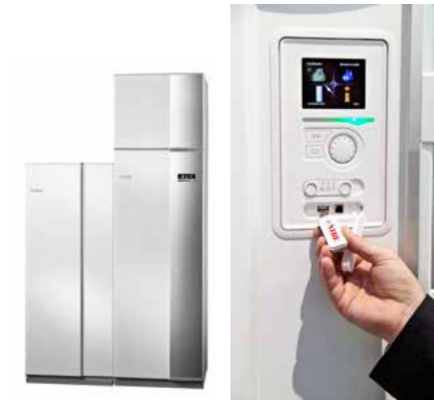
Technikpaket 3B Abluftwärmepumpe mit separatem 200-Liter-Warmwasserspeicher und integrierter Lüftungsanlage mit Wärmerückgewinnung (Zuluft dezentral, Abluft zentral)
