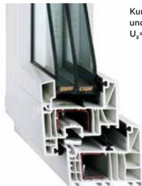
Kunststoffenster mit 6-Kammer-Profil und 3-fach Isolierverglasung,  $U_g=0,5 \text{ W/(m}^2\text{K)}$ , weiß
