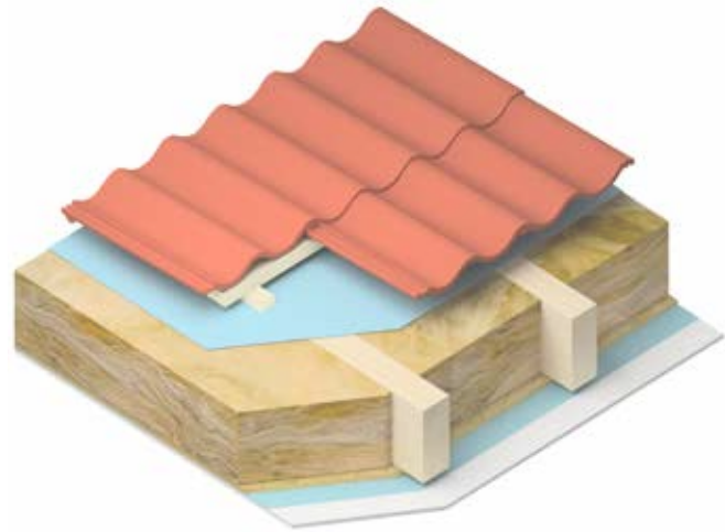
Schema der Dachkonstruktion
