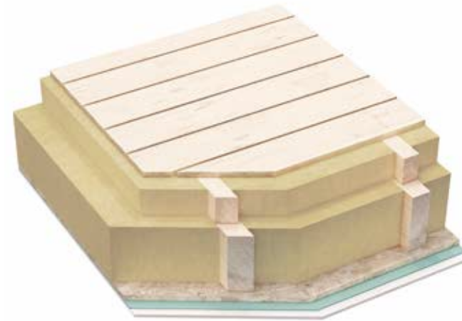
Aufbau der Kehlbalckendecke zum unbeheizten Spitzboden
